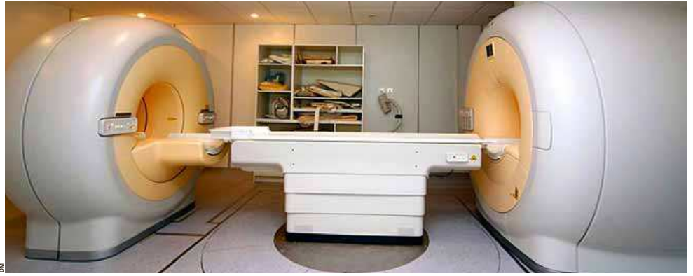
Equipo híbrido de tomografía por emisión de positrones (PET) y resonancia magnética (RM).
